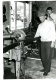
Slijpen van zagen in zagerij De Spiegelaere, Knesselare, ca. 1970 (HDSK_011)
